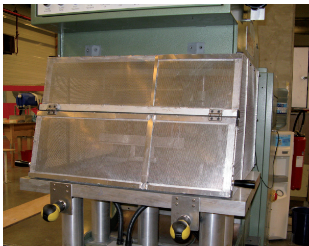
Figure 7. Blindage d'une presse HF
