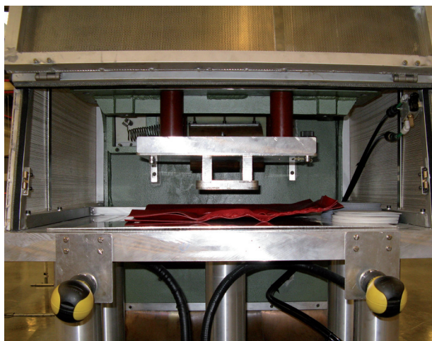
Figure 7. Blindage d'une presse HF
