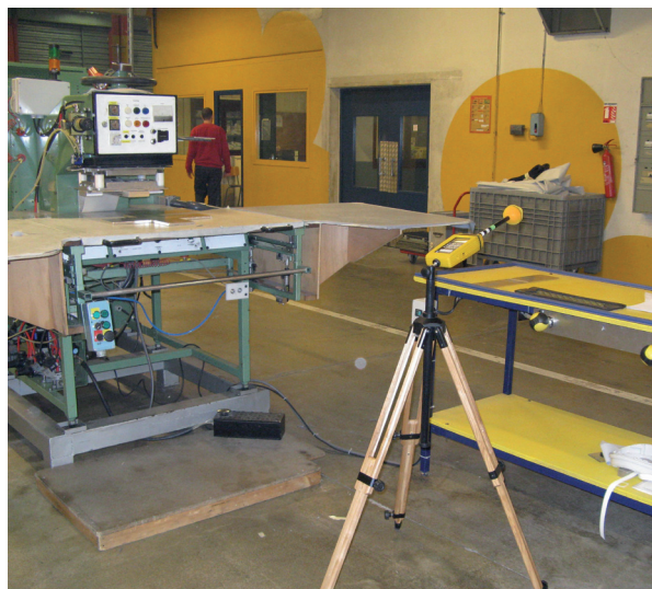
Figure 5. Mesure de champs sur presse HF
